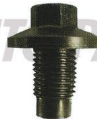
100 563 bujão cárter Ka/Fiesta/Courier/Focus/Escort SW M14x1,5x19
